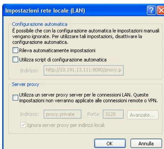
Fig.19: Configurazione del proxy web
